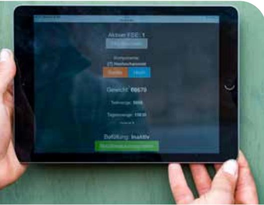
In Echtzeit werden auf dem Tablet-Display beim Befüllen des Feststoffdosierers die Mengen der Substratbestandteile angezeigt.
